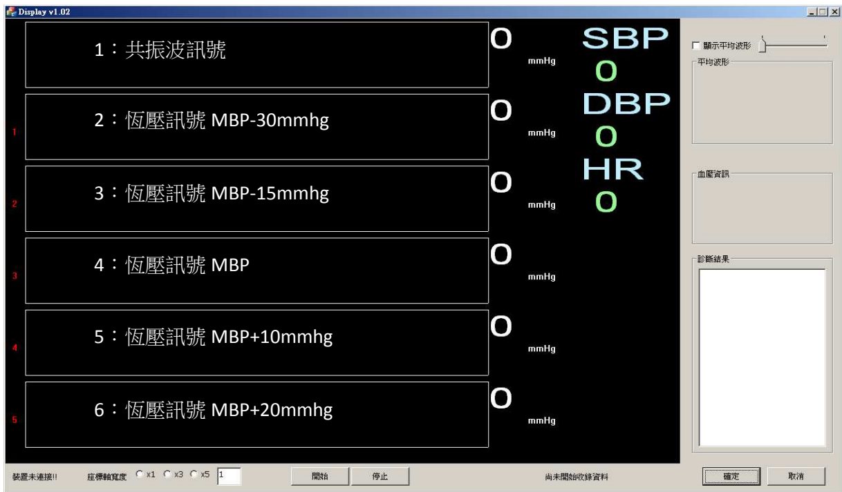
圖 5、波形顯示區之即時顯示分段區塊圖。波形訊號區中，包含共振波及恆壓訊號波內共有 6 個顯示波形區塊。
