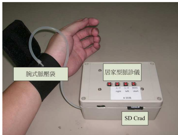
圖 22、居家型脈診儀；使用方式
