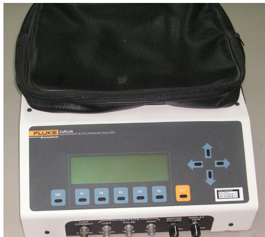
圖 14、脈搏訊號模擬儀器
